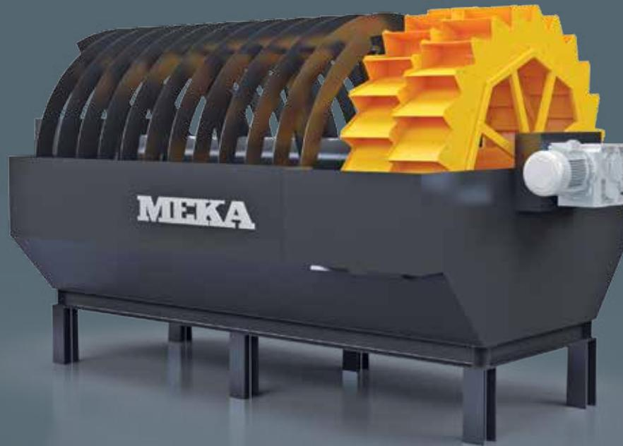
Les laveurs de sable à roue de Meka sont conçus avec un grand bassin de décantation qui assure la flexibilité du contrôle et de la fréquence d'alimentation. Ce type de laveur de sable est efficace pour éliminer l'alluvion, le silt et l'argile des matériaux tout en récupérant les matériaux extra-fins à partir de 200 µm. Les laveurs de sable à roue sont parfaites pour les matériaux abrasifs due à leur coût faible en termes des pièces d'usure.
