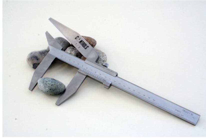
Şekil indeksi tespit kumpası.
