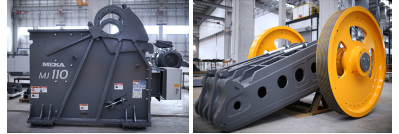
Kırıcı gövdesi ve pitman gurubu genel görünüşü.
