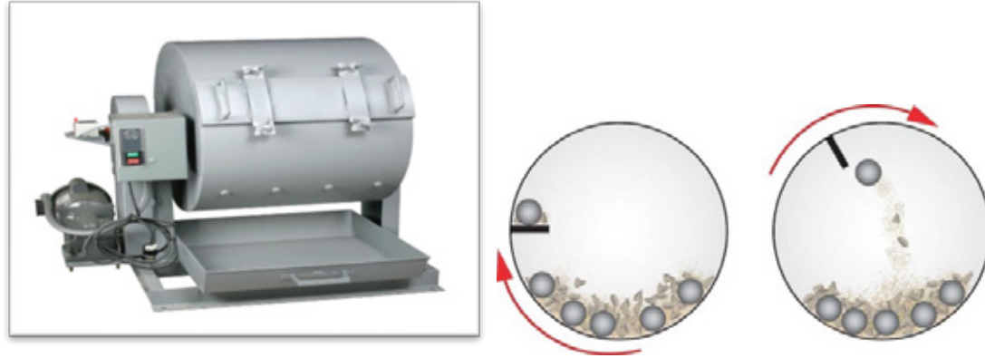
LA test cihazı prensip şeması ve görünüşü.
