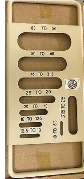
Yassılık indeksi ve uzunluk indeksi tespit cetvelleri.
